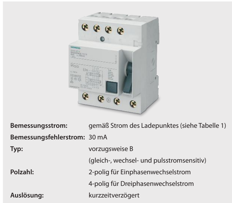
Bild 10: Fehlerstrom-Schutzschalter mit Kenndaten
